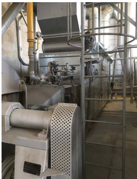
→ Vue avant du toasteur avec au premier plan le caisson du brûleur à veines d'air. On distingue au-dessus la trémie d'alimentation avec son alimentateur rotatif.
