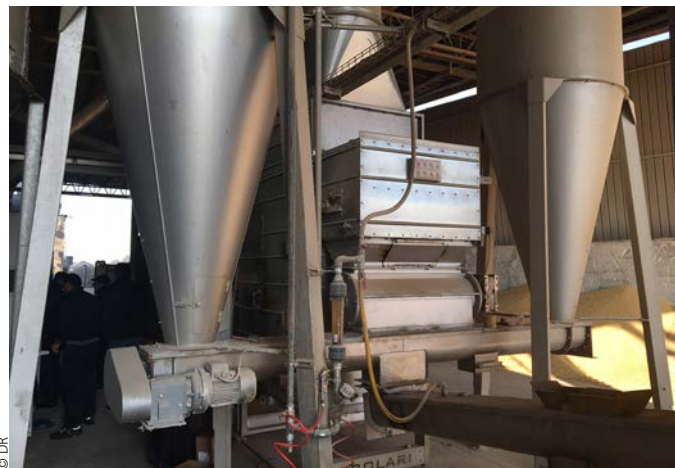
→ Évacuation du produit toasté avec la récupération des fines en mélange. Les fines sont des follicules ou enveloppe de graines dont la valeur nutritive est avérée.
