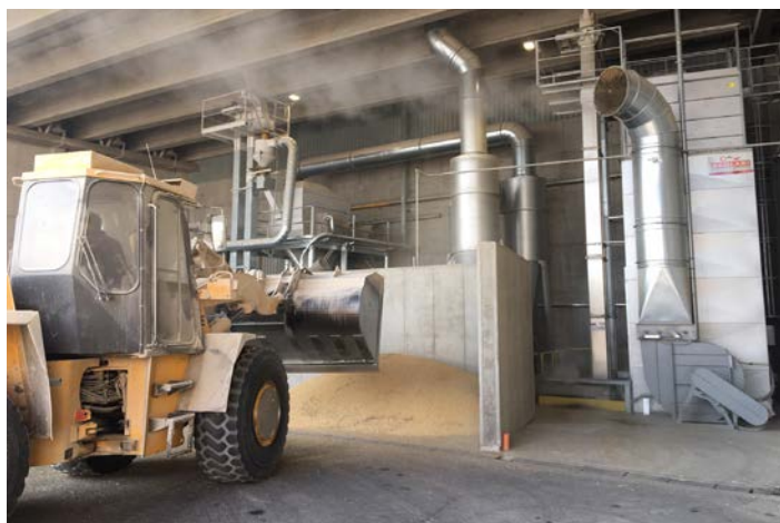
→ Le toasting de soja avant mise en stockage. Le soja est déposé dans une fosse de réception dédiée qui constitue la réserve amont d'alimentation et de régulation du toasteur.
